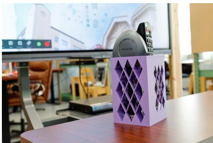
3Dプリンターで作成したオリジナルのワイヤレスドングル立て
